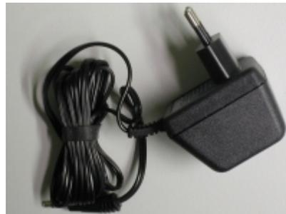
Safe Netz-Trafo Nr. 9887 zu Signoscope T1 Nr. 9886 (AC-Adapter) nach VDE 0551
