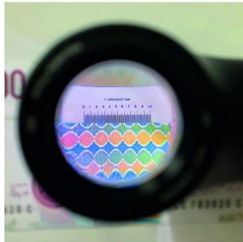
Leuchtturm LED-Auflagelupe mit 8-facher Vergrößerung und Skala Nr. 361737
